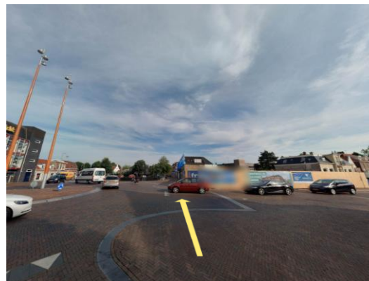
Figuur 7.11 – Wachtende auto's voor de haaiantanden blokkeren de looplijn van de voetganger (Streetsmart, 2019)
