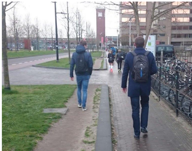
Afbeelding 3 – Gras liegt niet: voetpad te smal (bron: eigen foto)
