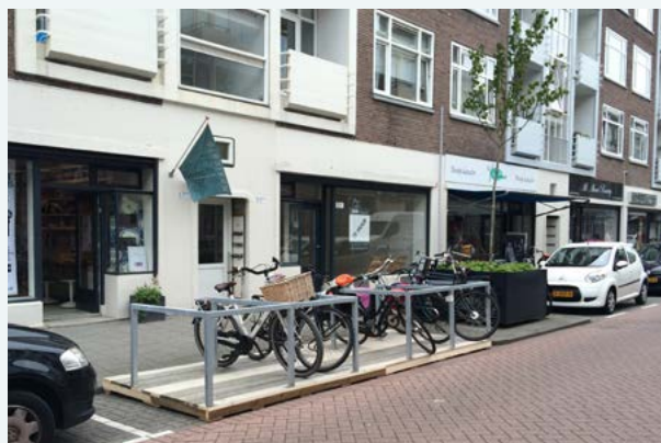
Als een stoep te smal is voor fietsparkeren, kan een parkeerplek worden gebruikt. Dat doen we in Rotterdam al d.m.v. een fietsvlonder.
